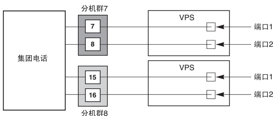
本例中使用 Panasonic KX-TVM50/KX-TVP50 系列 VPS，可以通过 4 接头线连接至集团电话的 4 个分机插口。
