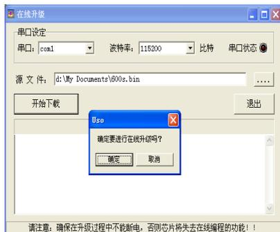
点击“确定”后对系统进行软复位，然后进行联机。软复位后所有正在通话的分机中断通话。联机成功后会自动开始升级。
