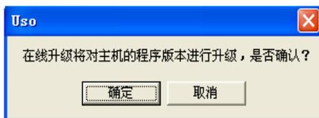
点击“确定”进入升级状态,其中串口自动提取,波特率为下载速度,默认为115200最大速度下载。源文件为公司提供的bin格式的下载文件,客户根据需要自行在公司网站下载(建议下载之前询问有关的技术人员,以免出现下载错误而造成系统运行不正常)。进入以下界面时,话务台串口自动关闭。
