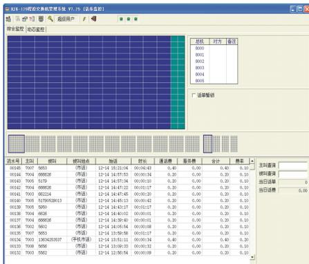
本窗口监视用户分机的使用情况，分别有摘机、挂机、通话、呼入、呼出等几种状态和实时显示所收到的话单及当前的总机状态。每页显示分机用户192门，中继32条，切换中栏面框可翻下页。
