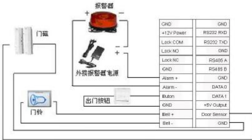
出门开关、门磁、门铃和报警器的连接图
